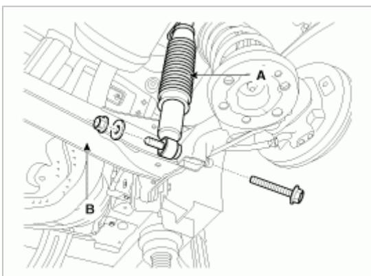
7. 拧下螺栓，从车身上拆卸扭力横梁车桥(A)。
