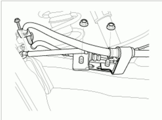
5. 拧下螺栓(A)，从扭力横梁车桥上拆卸制动钳总成(B)。
