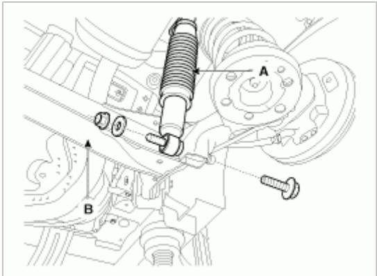
12. 拧下螺栓，从车身上拆卸扭力横梁车桥(A)。
