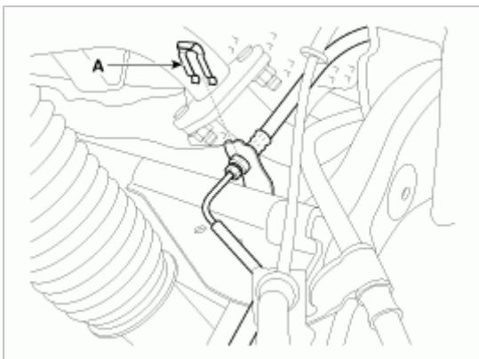
8. 拧下轮速传感器线束 (A) 螺栓与螺母和驻车制动拉线 (B) 装配螺母。
