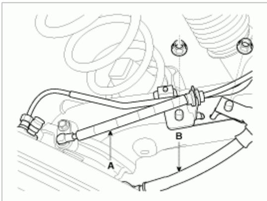
9. 拆卸制动软管 (A)，拧下工作缸螺栓。
