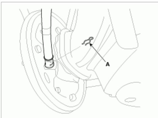
7. 拆卸驻车制动拉线夹 (A)。
