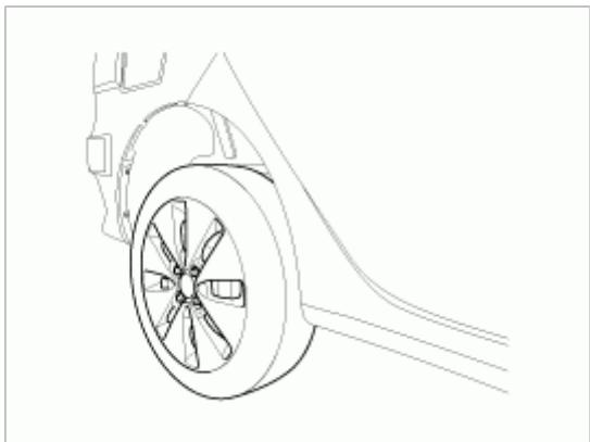
拆卸后车轮和轮胎时小心不要损坏轮毂螺栓。
