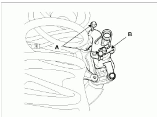
6. 拧下螺栓与螺母，从扭力横梁车桥(B)上拆卸后减震器(A)。
