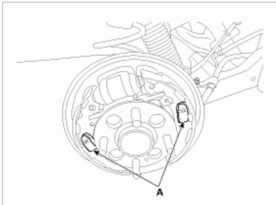
5. 从制动片 (B) 上分离驻车制动拉线 (A)。
